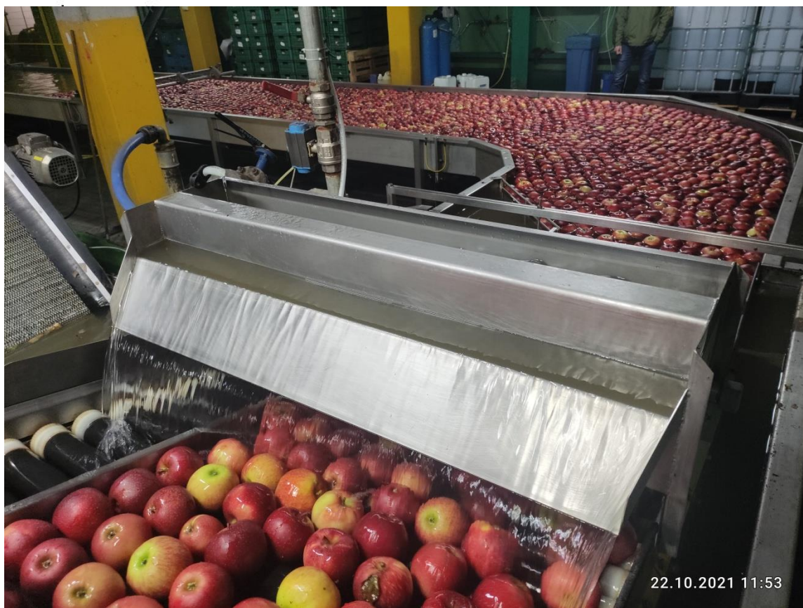
Fot. 2. Stanowisko do wodnego rozładunku owoców
